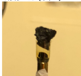
図1 ポリイミドチューブを利用した試料ホルダ。チューブの厚さは10 \mu\text{m} 程度で、分析に影響を与えない。また、ドリフトも1 \mu\text{m} 以下の精度である。
