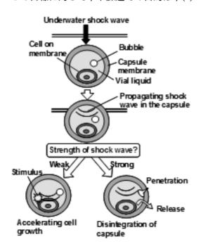
衝撃波作用時の"気泡崩壊"で"マイクロジェットまたは2次衝撃波"が"カプセル膜"に作用し"破膜"に至る現象を気泡変形挙動の可視化や圧力計測等によって調べ,破膜にいたる圧力制御を最適化することと,(2)カプセル内細胞培養可能のための条件算出と細胞への物理的刺激伝播の数値予測,を行うことである.
