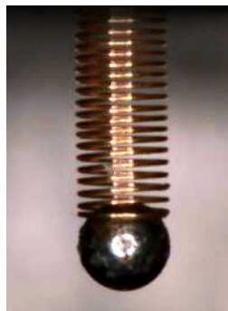
図2 超小型ばねによる1自由度振動
