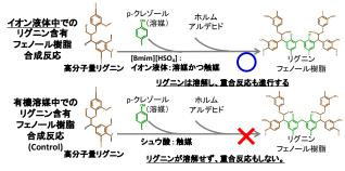
図 5. イオン液体を溶媒かつ触媒として 用いたリグニンの高分子修飾反応
