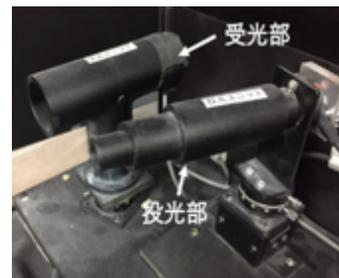
図 4 試作した光散乱型簡易エアロゾルセンサー
