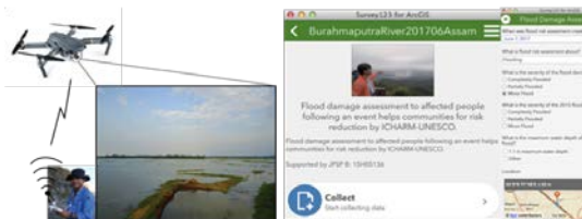
図. 3 ドローンで空撮した氾濫状況及び現地調査のモバイル用アプリケーションの例 (右)
