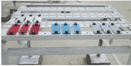
図 8 塗装鋼板の暴露試験状況
