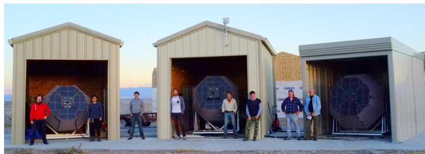
図 1. テレスコープアレイ観測サイトに設置した 3 基の新型大気蛍光望遠鏡。日本からの遠隔操作により定常観測を続けている
