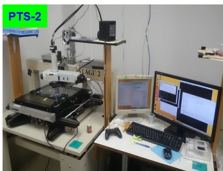
図.1 ナノスケール飛跡読み取り用光学顕微鏡システム (PTS-2)
