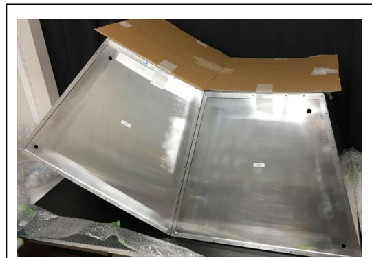
図1 溶接によって製作したゆがみ低減2連HBDチェンバー
