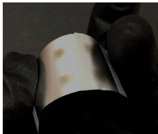
図 5. S@CNT を用いたフレキシブルなリチウム-硫黄マイクロ電池。研究開始当初は想定していなかった、「硫黄の機能化・資源化技術の開拓」に関する研究成果例。
