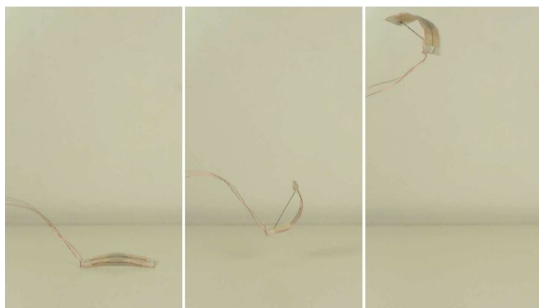
図 1: 弾性体アクチュエータモジュールによる跳躍
