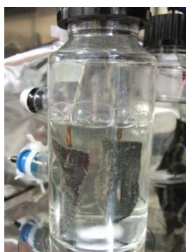
図2. メタンガスを活発に産生している微生物電解セル
