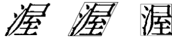
図 4 正規化処理の例 左から (a) 文字画像、(b) 外接平行四辺形、(c) 正規化画像
