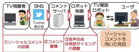
図3 SNS コメントを発話文として利用するTV雑談ロボット
