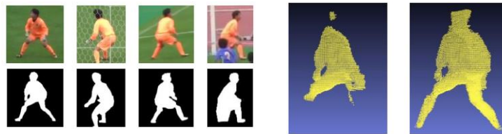
図2 ズームレンズカメラ映像を利用した視体積交差の精度向上. 左:被写体の4方向からの撮影映像とシルエット抽出結果. 右:視体積交差による3次元形状抽出結果(左側:従来法の結果, 右側:カメラパラメータ補正による結果)
