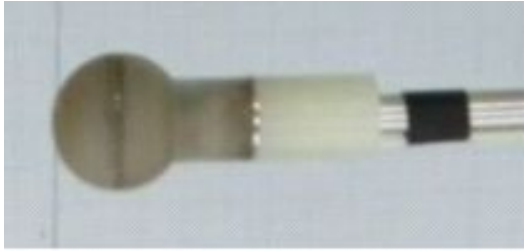
図1 試作した熱外中性子線測定用電離箱
