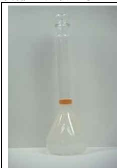
写真1 自発的にイオン会合体相が相分離している様子 有機陽イオンと有機陰イオン添加後15分経過。色素を添加し、イオン会合体相を着色
