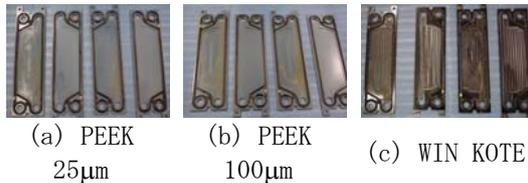
Fig. 12 連続運転後の表面状態 (左から温水/作動流体/温水/作動流体側)
