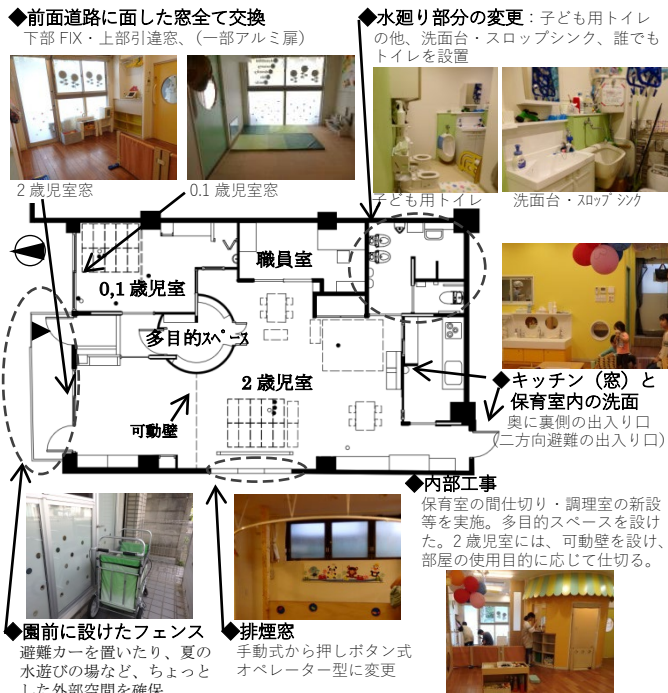
図12 転用時の主な改修工事内容
