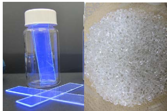
図7 新開発プラスチックシンチレータ シート状 (不揮発性化合物に最適) と 3mm のペレット状 (揮発性化合物に最適) の例
