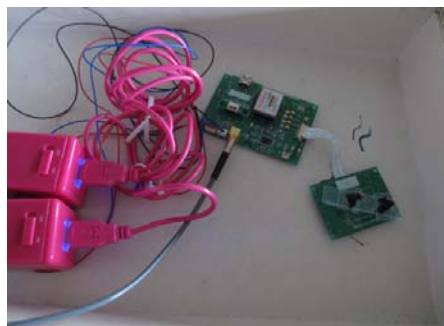
図1 MPPCに発光体と線源を置いた測定装置例
