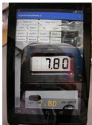
図3. アンドロイドタブレット(裏側においてあるpH計の7segLED表示)が画面に表示されている。
