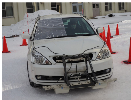
図3 人為的な悪視界下での走行実験 (左カーブ、路端にパイロンを置いている)
