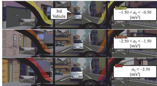
図2 先行車減速意図呈示インタフェース
