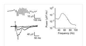
図 PEDOT:pTS 電極で測定されたニワトリ胚 脳におけるガンマ帯域活動と、刺激誘発電位
