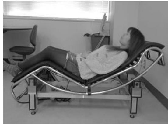
図 1 スイング型全身振動装置
