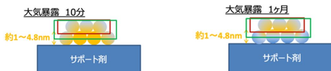
図11 大気暴露における酸化状態のモデル
