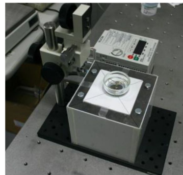
図 1: 作製したディスク EMS 粘弾性測定システム
