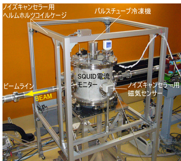
図3 理研プロトタイプ HTc SQUID ビーム電流計
