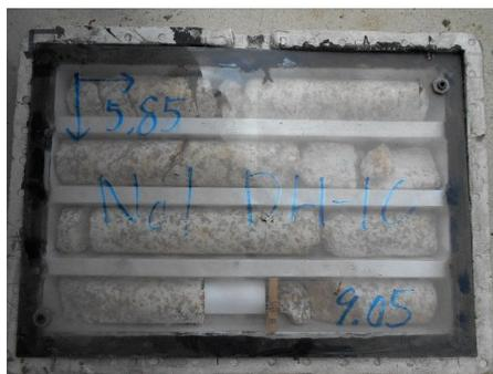
写真 1 . 土岐花崗岩ボーリングコアサンプル (5m)
