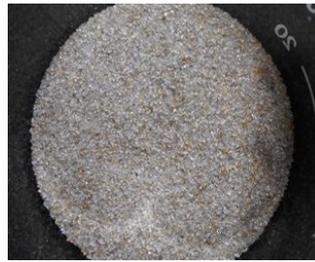
写真 3 . 石英沈殿物
