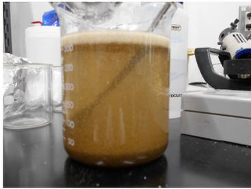
写真 2 . SPT 分離の様子。石英沈殿物と長石浮遊物
