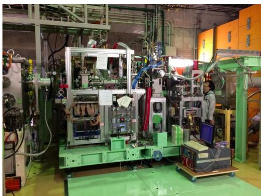
Fig.3 レール装置に設置された不安定核弾性散乱測定装置(ESPRI)——F12 コース
