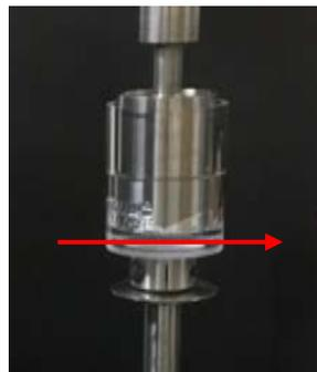
図 4.6  $\tau_s$  を測定する際に用いたクエット。 $\tau_r$  は、Ti 製ボブとガラス製カップの隙間部のレーザー光の散乱量で求めた。
