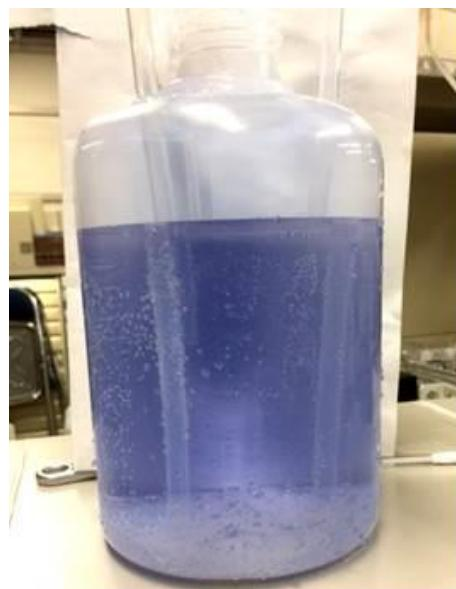
図5 アノード水タンク中の超高濃度オゾン水 (159 mg/L)
