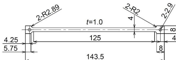
図 3 試験片の形状および寸法
