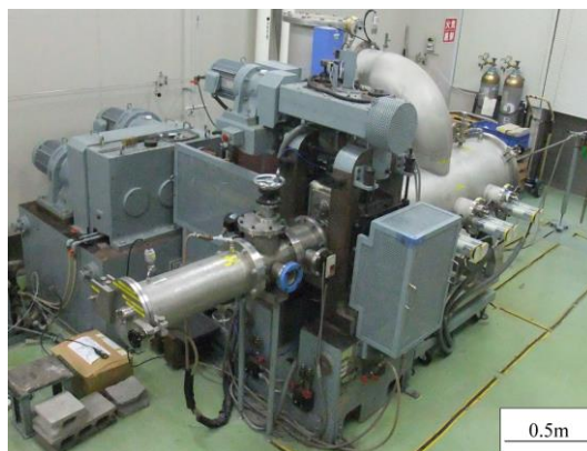
図1 真空圧延機外観
