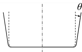
図4 U曲げ後のスプリングバック角度
