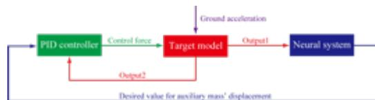
図2. 神経振動子と位置制御器を利用した動吸振器制御システムのブロック線図
