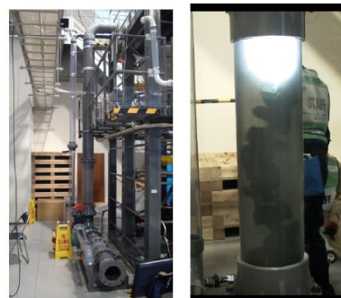
図 3 実験模擬プラント（内径 200mm 配管）と内部を移動するヘビ型ロボットの様子
