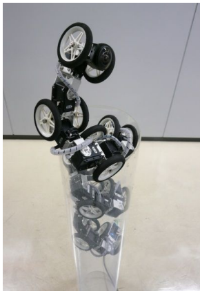
図1 配管内を移動するヘビ型ロボット
