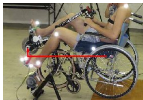
図2 FESサイクル: 4輪型 (上, BB 高さ=500mm), アップライト型 (中, BB 高さ=260mm), リカンベント型 (下, BB 高さ=580mm)
