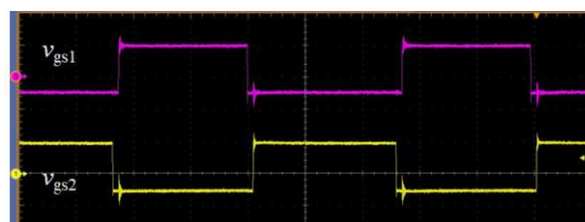
図7 Q_1 、 Q_2 のゲート-ソース間電圧
