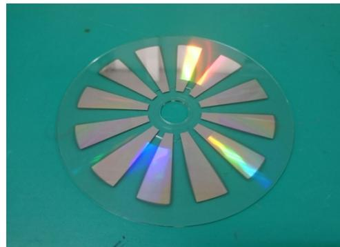
図7：試作した2層ディスク用1層デ
