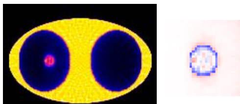
図 3 完全投影データからの再構成結果(左)と残差(右:(色は赤が正,白が0,青が負を表す))
