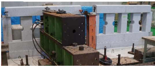
写真2 石材高欄の模型 接着のみ模型(左)と接着と補強した模型(右)
