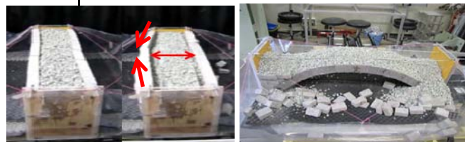
加振前 加振後 (c)壁石の開き(孕みだし) (d)中詰材の流出
