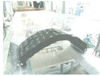
写真3 実験水路と石アーチ輪石模型
