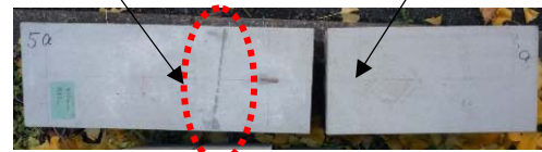
(b) 砂岩の供試体 5 (Ls=400mm)
