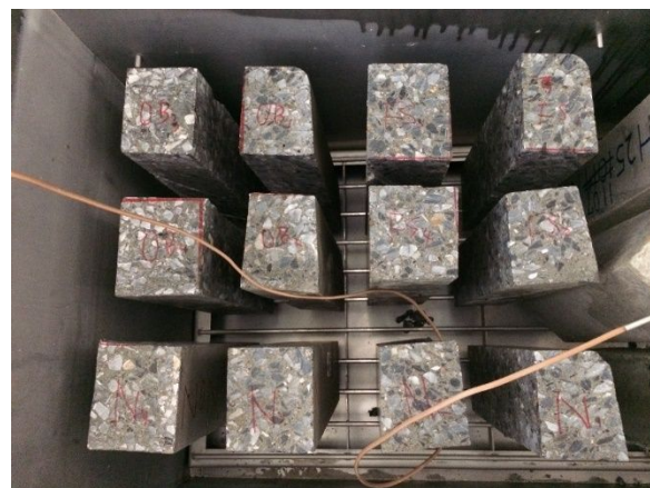
図-3 10×8.5～7.5×40cm に切断した供試体での ASTM-B 法の凍結融解試験
