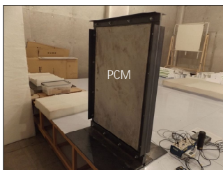
図 - 2 PCM の設置状況
