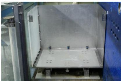
写真2 振動载荷装置
