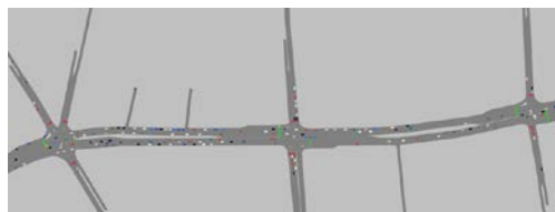
図5 ミクロ交通流シミュレーションによる実交通流の再現
