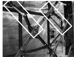
図8 外弦材の座屈 ( \gamma=1/50 )
