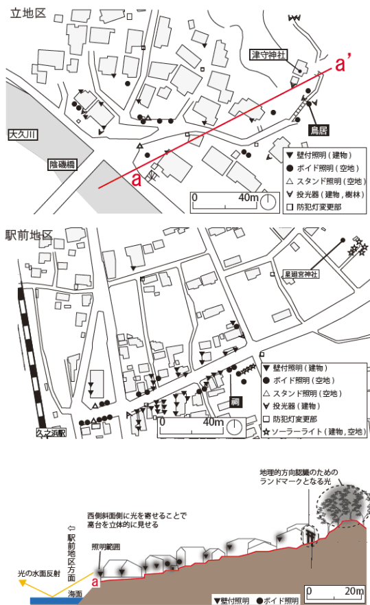
図1 いわき市久之浜の照明実験配灯図 上: 高台となる立地区の配灯図 中: 久之浜駅前通り周辺の配灯図 下: 立地区の断面模式図。高台と避難経路を可視化するために、斜面の建物の西側に光を取り付けている。
