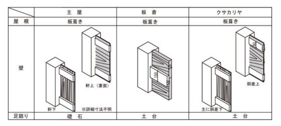
図 2.M 家屋の壁面の特徴
